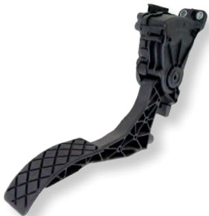
El sensor de posición del acelerador es un **dispositivo electrónico** que **detecta la posición del acelerador** traduciendo la presión ejercida por el conductor y transmitiendo esta información al ordenador del motor (ECU). Este último **ajusta la cantidad de combustible inyectado** y la apertura de la mariposa del acelerador, lo que permite una buena gestión del par motor, el consumo de combustible y las emisiones contaminantes.
