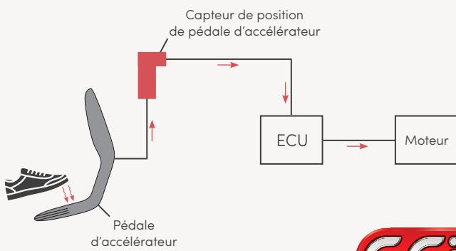
Principe de fonctionnement du capteur de position de pédale d'accélérateur
