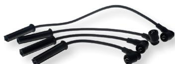
Le faisceau d'allumage est un élément essentiel du système d'allumage des moteurs thermiques à essence. Son rôle principal est de **transporter l'électricité haute tension générée par la bobine d'allumage jusqu'aux bougies d'allumage**. Cela permet de produire l'étincelle nécessaire à l'inflammation du mélange air/carburant dans les cylindres du moteur.
