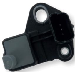
Le capteur de position de vilebrequin est un **composant électronique essentiel du système de gestion moteur**. Il mesure **précisément la position angulaire et la vitesse de rotation du vilebrequin**, permettant à l'unité de commande électronique (ECU) d'ajuster les paramètres de fonctionnement du moteur.
