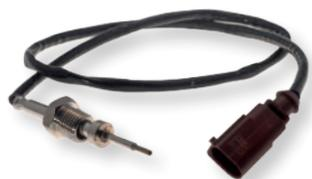
Le capteur de température d'échappement est un dispositif utilisé dans les véhicules pour **mesurer la température des gaz d'échappement**. Son rôle dans la régulation du fonctionnement des systèmes de post-traitement des gaz d'échappement apparaît essentiel. En effet, il minimise les émissions, protège les composants du moteur et optimise les performances.
