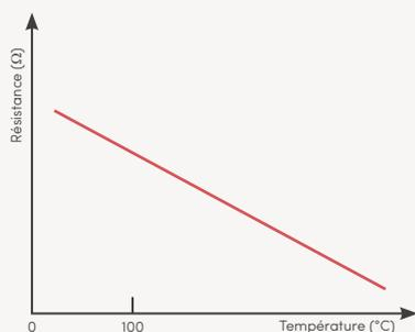
Principe de fonctionnement de la technologie CTN (Coefficient de Température Négative) : plus la température augmente, plus la valeur de la résistance diminue.
