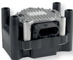
La bobina de encendido es un componente esencial del sistema de encendido de los motores de combustión interna que funcionan con gasolina. Su función principal es **transformar la baja tensión de la batería (12 V) en la alta tensión (de 15.000 a 40.000 V) necesaria para crear una chispa en la bujía**. Esta chispa enciende la mezcla de aire y combustible en la cámara de combustión, asegurando la combustión en el motor.
