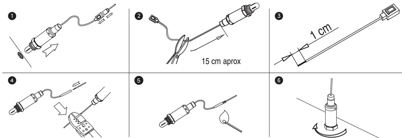
1. Déconnectez la batterie, débranchez et retirez le connecteur de la sonde lambda à remplacer.
