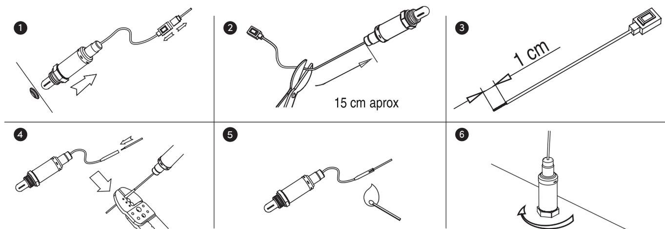
1. Desconecte la batería, desenchufe y retire el conector de la sonda lambda a sustituir.
