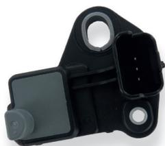
El sensor de cigüeñal, también llamado **sensor PMC** o **sensor de régimen**, permite indicar al calculador la **posición del cigüeñal** y su **velocidad de rotación**. Esta información es esencial para **ajustar la inyección del combustible**, permitiendo principalmente al calculador saber **cuándo inyectar el combustible del (o los) cilindro(s) correcto(s)**.
