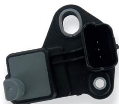
Le capteur de vilebrequin, également appelé **capteur PMH** ou **capteur de régime** permet d'indiquer au calculateur la **position du vilebrequin** ainsi que sa **vitesse de rotation**. Ces informations sont essentielles pour **ajuster l'injection de carburant**, permettant principalement au calculateur de savoir à **quel moment injecter le carburant dans le (ou les) bon(s) cylindres**.
