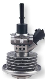
Le système d'injection d'urée a pour rôle d'**injecter un fluide appelé AdBlue®** (mélange d'eau déminéralisée et d'urée) **dans le flux d'échappement** du véhicule avant que les gaz ne passent dans le catalyseur SCR.
