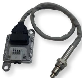
La sonde NOx a pour rôle de **mesurer en temps réel la concentration des oxydes d'azote (NO et NOx) dans les gaz d'échappement**. Ces gaz sont des polluants majeurs produits dans les moteurs à combustion interne, surtout à haute température. **Les données collectées par la sonde sont transmises au calculateur (ECU) qui ajuste alors le système de dépollution (en injectant de l'AdBlue®) pour réduire les émissions de NOx.**
